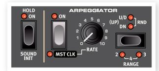
El arpeggiador se puede usar con las direcciones "Up" (arriba), "Down" (abajo), "Up/Down" (arriba/abajo) o "Random" (aleatoria) en varios rangos de octava. El tempo de las notas arpegiadas se fija con el control "Rate" o sincronizando el arpegio al "Master Clock" del Nord Stage 2.
