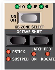
Mantenga pulsado “Shift” y pulse el botón izquierdo de octava en la correspondiente sección de instrumento, para activar el pedal de “sustain” para un instrumento. El LED “Sustped” se ilumina cuando se enciende. Vuelva a pulsar para activar la recepción de “Pitch Stick” y una tercera vez para tener ambas funciones. Pulsar por cuarta vez los desactivaría, como indicarían los LEDs.
