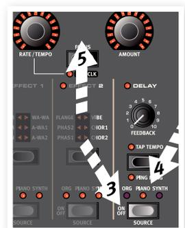
Si tiene más de un efecto activado en un programa, puede cambiar el enfoque pulsando el botón "Focus" situado entre los codificadores. El enfoque se establecerá automáticamente cuando se active un nuevo efecto.
