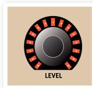
Los mandos tipo potenciómetro mostrados a la derecha se usan, por ejemplo, en las secciones “Synth” y “Effect”. Al desplazarse por los programas, la posición física de estos mandos no siempre reflejará correctamente los valores activos del parámetro, pero tan pronto se gire uno de ellos, dicho valor se ajustará inmediatamente a la posición de ese mando.
