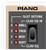
*Se accede a la configuración “Med/Soft” manteniendo pulsado “Shift” y pulsando el botón “Slot Detune/Clav EQ”.*
