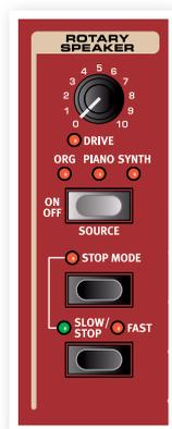
“Rotary Speaker”, sólo para los rotores ). Cuando se vuelve a pulsar “Slow/Stop” los rotores aceleran hasta la configuración de velocidad rápida “Fast”. Esta función imita el comportamiento de los primeros altavoces rotatorios de una velocidad.
