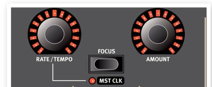
"Effect 1" y "Effect 2"), el botón "Focus" se usa para seleccionar qué configuraciones de efectos ("Rate"/"Tempo" y "Amount") "ve" y puede editar en ese momento. Pulsar el botón "Focus" alternará el enfoque entre los efectos activados en ese momento. El LED situado junto a la sección "Effect 1"/"Effect 2"/"Delay" correspondiente se ilumina para indicar el efecto enfocado.
