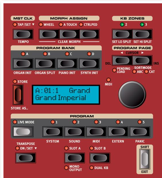
La sección de programas "Program" le da acceso a funciones de ejecución como recuperación y almacenamiento de programas, páginas de sistema/menú, etc. Los cuatro menús y sus configuraciones serán tratados en una sección separada, a partir de la página 42. En esta sección explicaremos las características, empezando con los botones situados en la parte inferior izquierda de la sección "Program".
