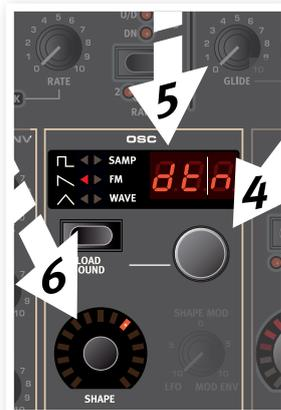
El parámetro "Shape" tiene varias funciones, dependiendo de la forma de onda seleccionada. Controla por ejemplo el ancho de pulso de algunas formas de onda; sobre otras no tiene efecto.
