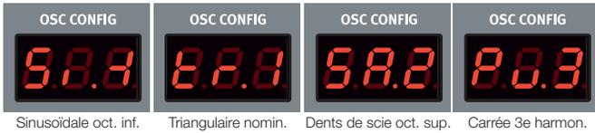
Quatre configurations mixtes ajoutent un second oscillateur avec une forme d'onde et une relation de partiel harmonique avec l'oscillateur 1. Les configurations mixtes sont affichées avec la forme d'onde et la valeur numérique d'un partiel harmonique en écran Osc Config. Voici quelques exemples :
