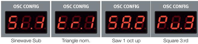
Bei den vier Mix-Konfigurationen wird Oszillator 1 mit einem zweiten Oszillator mit einer Wellenform und einer auf Oszillator 1 bezogenen harmonischen Teilschwingung erweitert.
